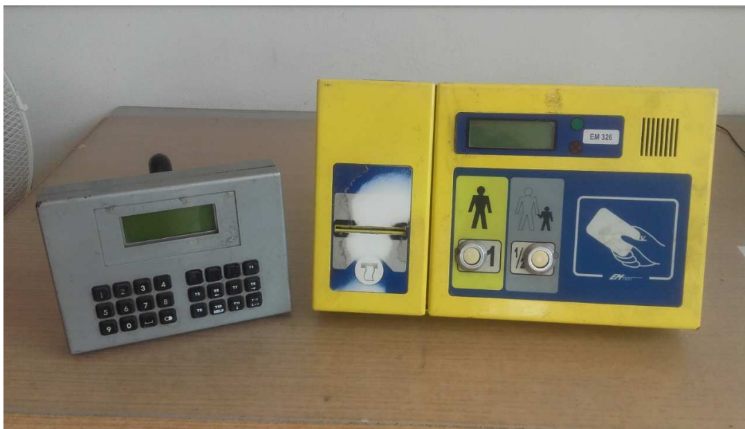
Jedna z prvých elektronických pokladní na výdaj cestovných lístkov. Umožňovala aj tzv. bezhotovostný spôsob výdaja lístkov prostredníctvom čipovej karty
